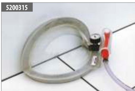
Prüfglocke Kehlnaht innen 3/8
