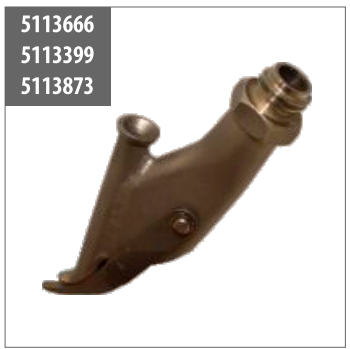
Schnellschweißdüse rund mit Heftschnabel, M14 Ø 3mm, Best.-Nr. 5113666 Ø 4mm, Best.-Nr. 5113399 Ø 5mm, Best.-Nr. 5113873
