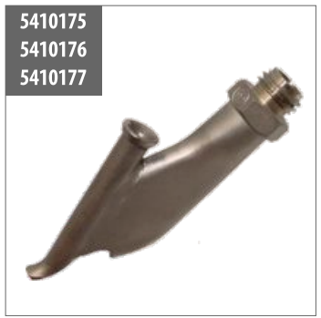
Schnellschweißdüse für Runddraht mit Gewinde M10 Ø 3mm, Best.-Nr. 5410175 Ø 4mm, Best.-Nr. 5410176 Ø 5mm, Best.-Nr. 5410177
