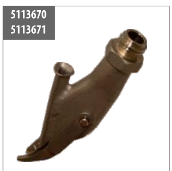
Schnellschweißdüse Profil mit Heftschnabel, M14 5,7 x 3,7mm, Best.-Nr. 5113670 7 x 5 mm, Best.-Nr. 5113671
